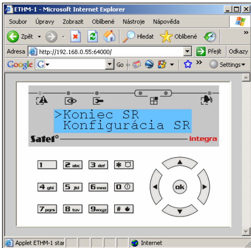
Obr. 10 Virtuálna klávesnica umožňujúca obsluhu zabezpečovacieho systému z WWW stránky.
